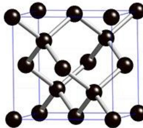
L'exemple du cours pour le calcul de la capacité calorifique d'un solide est un modèle d'un cristal qui a 3 liaisons élastiques sur Ox, Oy, Oz. On a  $f = 6$ . Qu'en est-il pour un cristal avec des atomes tétravalents (4 liaisons) comme le diamant ?
